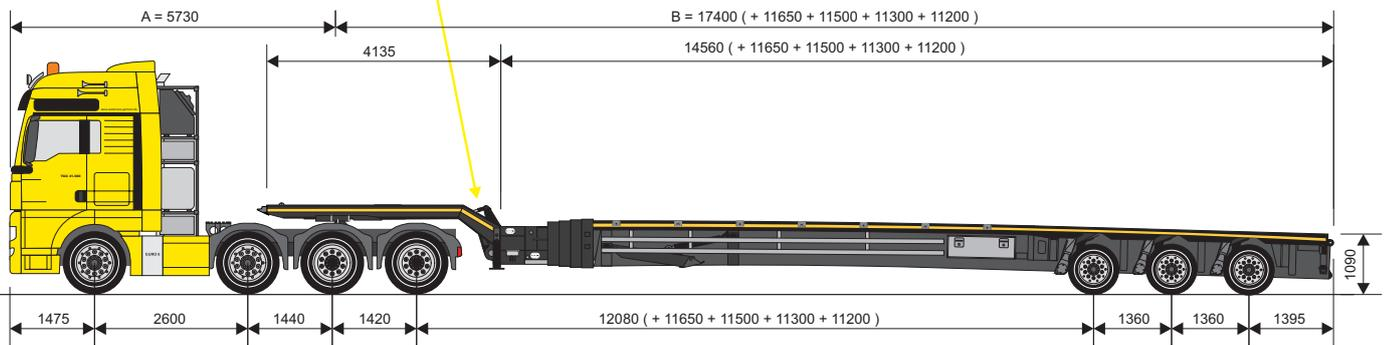
Der SUPER WING CARRIER wurde speziell für den einfachen und effizienten Straßentransport von langen Windrad-Rotorblättern entwickelt. Sie können so die bis zu 70 m langen Blätter optimal auf der Straße transportieren.
