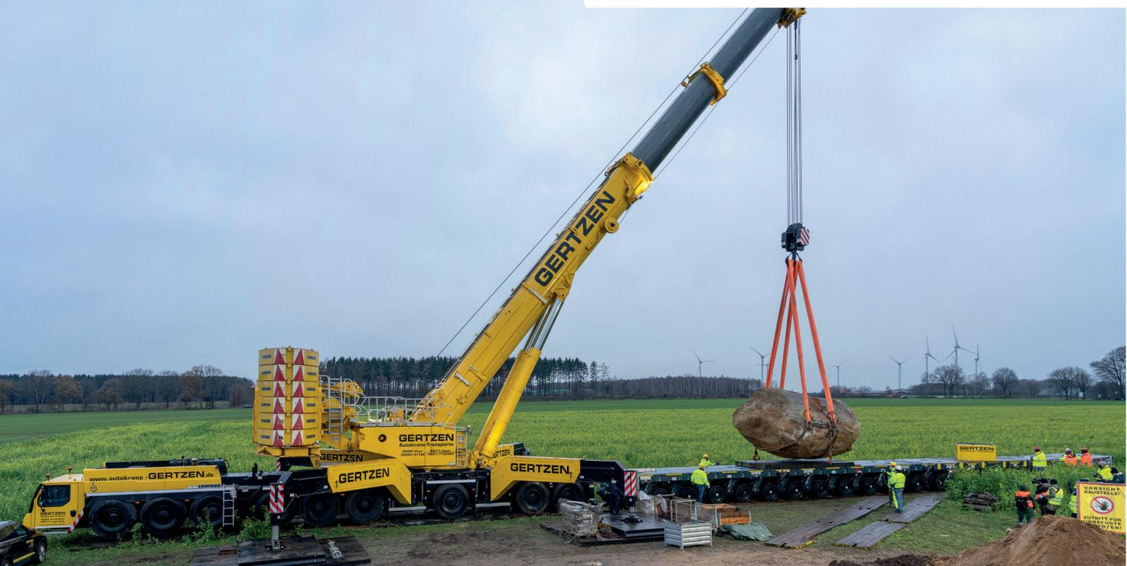
Dieser Liebherr-Mobilkran ist auf sehr kurze Rüstzeiten ausgelegt. Er besitzt eine hohe Tragkraft und kann mit verschiedenen Auslegersystemen versehen werden. Der 9-achsige Kran ist in der Lage seinen kompletten Teleskopausleger im Straßenverkehr mitzuführen. Durch die modifizierte Leerfahrkonfiguration reduziert sich das Gesamtgewicht auf nur 99 Tonnen. Hubarbeiten sind auch mit einer Abstützbasis von 10 x 10 m möglich.
