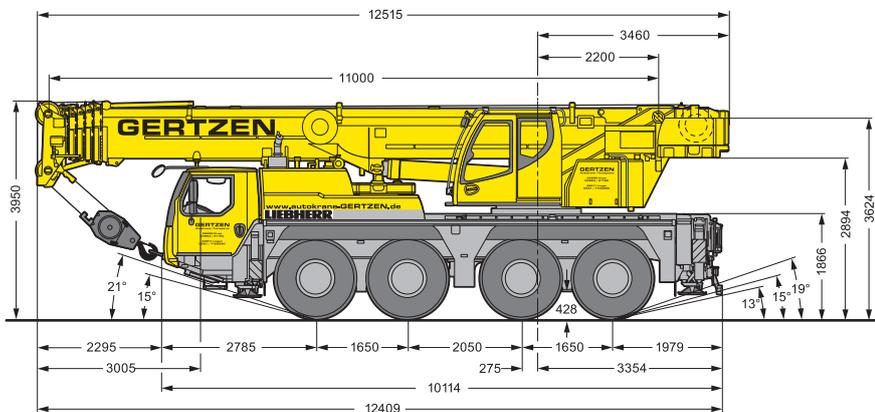
Der auf 4 Achsen montierte LTM 1070-4.2 ist in Windeseile einsatzbereit, da er den Großteil seines Ballastes bereits auf dem Fahrzeug mitführt.
