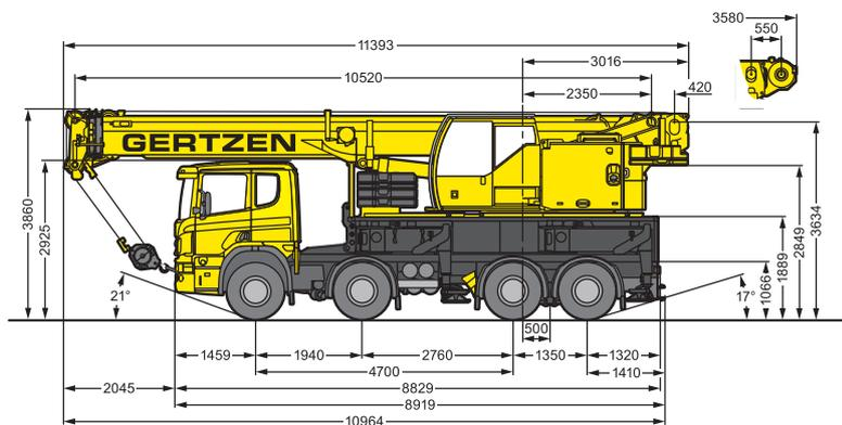
Der LTF 1045-4.1 fährt auf einem serienmäßigen, 4-achsigen LKW-Fahrgestell und ist daher sehr mobil und schnell am Einsatzort. Mit seinem großzügigen Teleskopausleger eignet er sich besonders gut für die Montage von Fertigbauteilen. Schnelligkeit, Genauigkeit und sicheres Handling zeichnen diesen Mobilkran aus.
