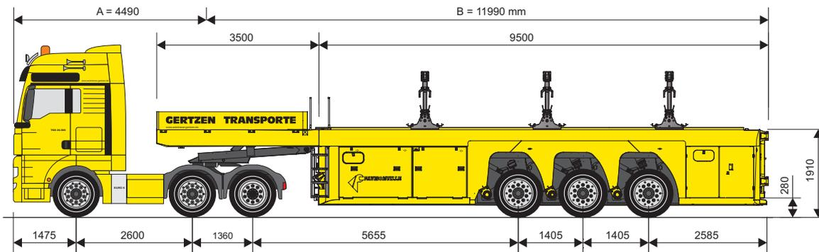
Typische Lasten für einen Innenlader sind sperriges oder stehend zu transportierendes Ladegut, wie zum Beispiel Fertighauselemente. Für besondere Aufgaben stehen neben den Standardpaletten auch Tiefladepaletten zu Verfügung.
