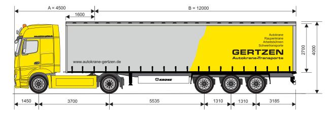
In der Lade- und Transportkalkulation von "normalem" Ladegut, aber mit flexiblen Höhen und Breiten bietet sich diese Art von Trailer an. Zusätzlich verfügt der Krone Profi Liner über ein Planensystem für einen Sichtschutz oder für wettersensible Ladungen.
