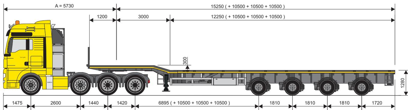
Telesattelaufleger, wie dieser 4-fach-teleskopierbare Trailer sind Spezialisten besonders für lange Ladungen. Mit einer nutzbaren Länge zwischen ca. 16 m – 48 m. Eingesetzt in der Bau-, und Windkraftbranche, aber auch intern um Kranelemente zum Einsatzort zu transportieren.
