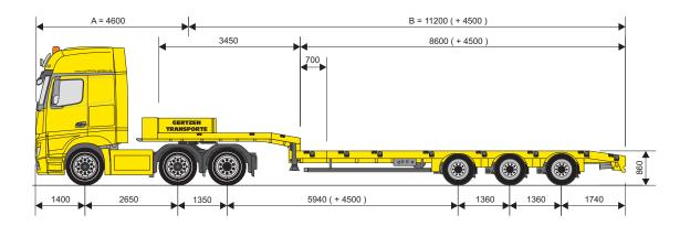
Ausgestattet ist dieser Semi-Tieflader mit einer nachlaufgelengten Achse, sowie einem 250 mm Zwischentisch zur Lastenaufnahme.
