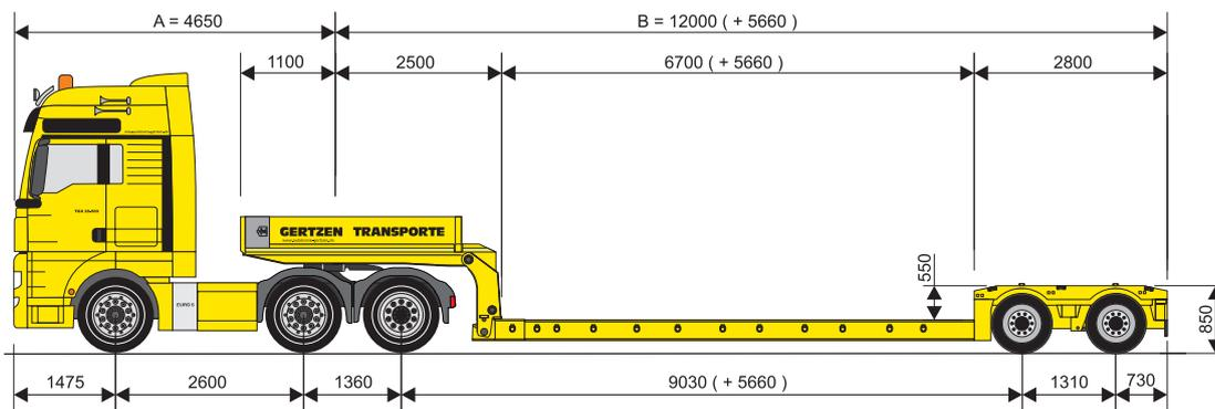
Unsere teleskopierbaren 2-achs Tiefbetten sind optimal für den Transport von Fahrzeugen und Industrieanlagen ausgelegt. Für besonders lange Ladegüter ist ein doppelt teleskopierbares Flachbett mit einer Länge im Bett von 6,85m bis 17,45m verfügbar.
